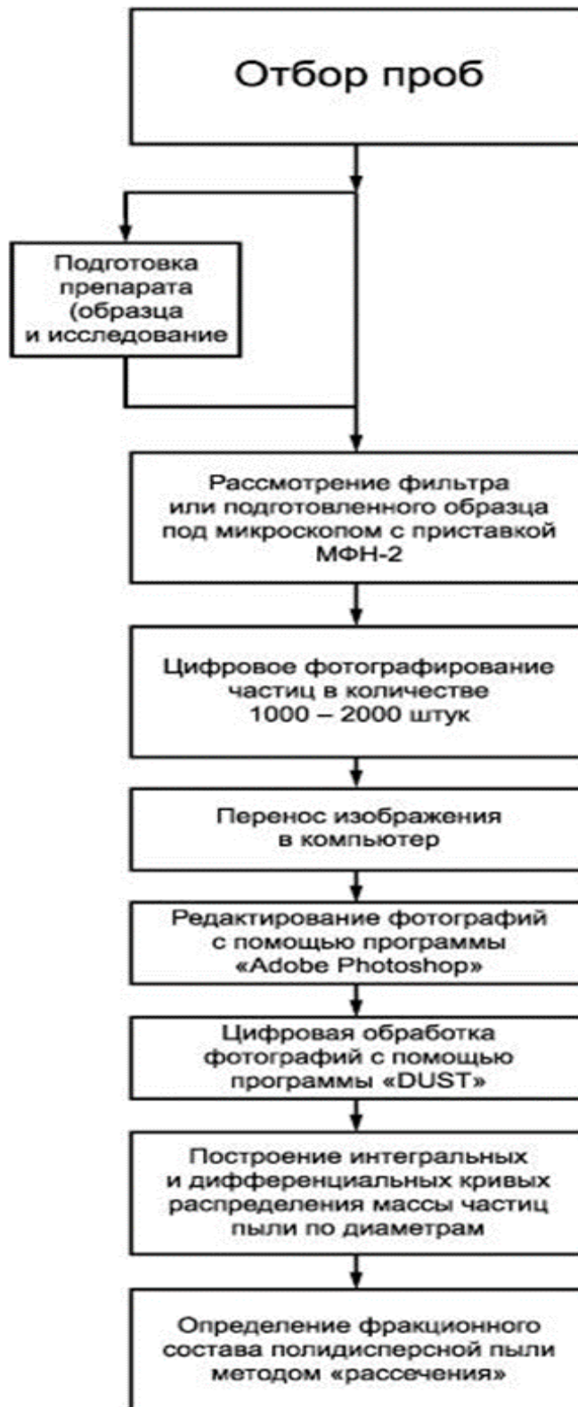
Рисунок 15 – Блок-схема методики микроскопического анализа аэрозольных частиц (по ГОСТу Р 56929-2016)
